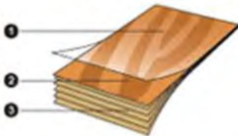
Il est obtenu par empilage de feuilles de papier imprégnées de résines thermodurcissables et polymérisées sous haute pression (8MPa) et à haute température (140°C). Epaisseur 0,8mm
