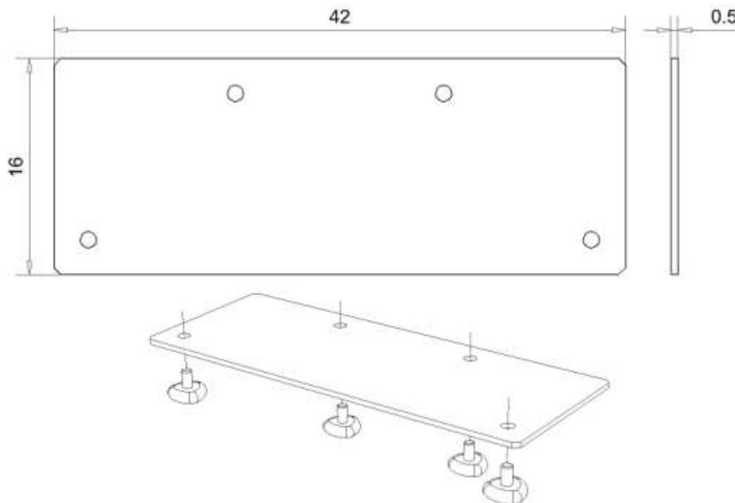
En tôle d'acier, elle s'utilise pour relier des plateaux entres eux, permettant de supprimer un pied. Elle se fixe à l'aide de 4 diabolos. Finition : peinture epoxy HAWORTH.
