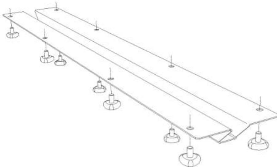
En tôle d'acier, il s'utilise pour relier des plateaux entre eux, permettant de supprimer un pied. Il se fixe à l'aide de 8 diabolos. Finition : peinture epoxy HAWORTH.
