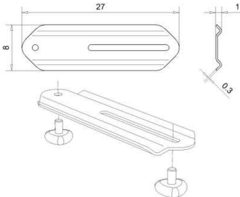
En tôle d'acier, elle s'utilise pour relier des plateaux entres eux, permettant de supprimer un pied. Elle se fixe à l'aide de 2 diabolos. Finition : peinture epoxy HAWORTH.
